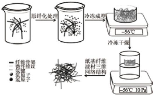
采用冷冻干燥技术制备纸基空气滤材流程图
