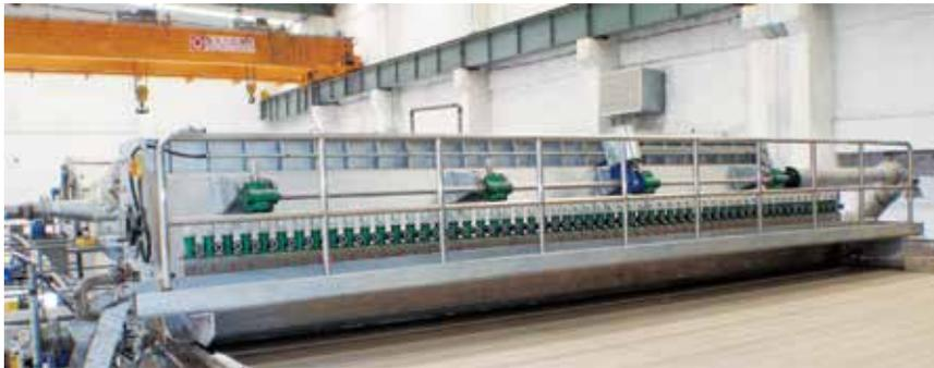
长网纸机气垫匀浆辊式流浆箱
