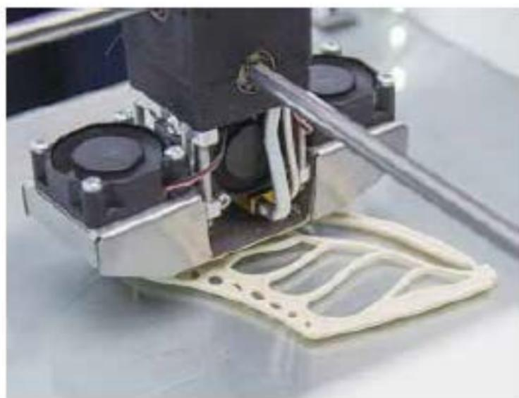
UPM 近日推出了一款专门为3D打印而开发的新型生物质复合材料——Formi 3D，该材料是将先进的纤维素纤维和生物聚合物技术相结合的产物，具有哑光效果，表面触感自然，且可以生产出深浅两种颜色。Formi 3D 经过精心设计，能够平稳地流过3D打印机的小喷嘴，打印出精美的细节。其快速冷却和低收缩率确保了尺寸的稳定性，这也使其成为大规模3D打印的理想材料。该材料在熔融状态下具有自支撑特性，能够在没有支撑材料的情况下形成圆形或其它复杂形状。另外，还可进行印刷后处理，具有良好的打磨性，易于与 PVAC 黏合。Formi 3D 以颗粒形式生产和销售，可用于传统的3D打印机，也可以直接用于大幅面3D打印。典型用途包括用于如建筑领域的模型、设计、教育及概念模块等。Formi 级材料已通过 FSC 和 PEFC 认证。 ▀
